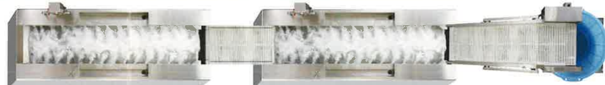
■ 洗浄水・殺菌水・冷却水・循環 冷水温度(5℃) ろ過機使用(0.3m 3 /時)
