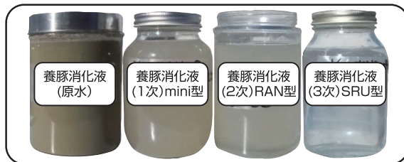
養豚消化廃液 処理
